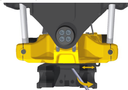
Afbeelding19. Draai de snelwissel naar rechts.
